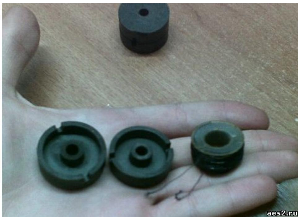
Первичная обмотка содержит 10 витков с отводом от середины, намотана она 3-мя жилами провода с диаметром 0,5 мм. После намотки первичной обмотки ее нужно изолировать изоляционной лентой и поверх мотать вторичную обмотку. Она имеет 400 витков провода 0,2 мм. Не забудьте через каждые 50-70 витков ставить изоляцию прозрачным скотчем или изоляционной лентой (можно использовать и конденсаторную бумагу). Затем собираем наш мощный электрошокер по схеме.
