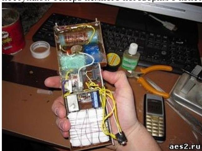
Задающий генератор выполнен на микросхеме SG3525, она настроена на частоту порядка 50 кГц. Транзисторы можно заменить на IRFZ44 или на отечественные КТ819, КТ805. Трансформатор: Ш-образный ферритовый трансформатор от компьютерного блока питания, берите тот который побольше (возможно и использование ферритовой чашки).
